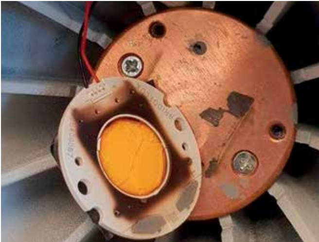
Die Auswahl des falschen thermischen Interface Materials kann zum Totalausfall von LEDs führen.
