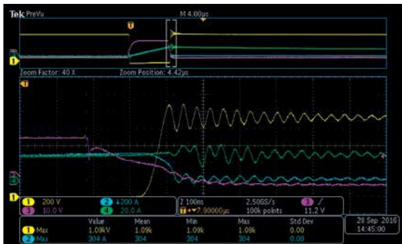
Testdaten mit 900 V DC Busspannung, 304 A Abschaltstrom, 200 V Span- nungsüberhöhung und 100 V Designmarge
