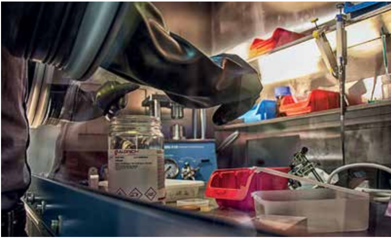
Batterieentwicklung ist sehr viel Chemie: Eine Handschuhbox schützt die Forscher beim Zusammenfügen der empfindlichen Chemikalien.
