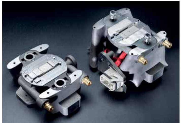
Belastungsoptimierte Spritzgusswerkzeuge lassen sich mit 3D-Druck zuverlässig und kostengünstig herstellen.
