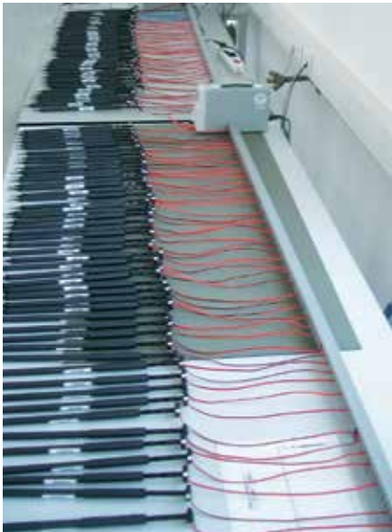
Die Bestromung von Automotive Sensoren hilft, die Funktionalität langfristig sicherzustellen.
