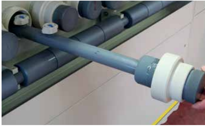
Wartungsfreundlich: Einfacher Ausbau des Düsenrohres für einfache Wartung der Pill-Systeme.
