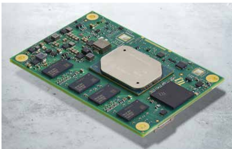
Abbildung 1: Falls Entwickler nicht auf einen ARM-Prozessor setzen möchten, ist es sinnvoller ein COM-Express-Mini-Modul, wie das TQMxE39M, zu verwenden, anstatt auf den SMARC-2.0-Formfaktor zu setzen.
