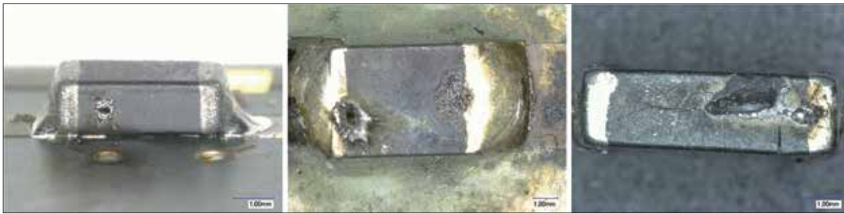
Abbildung 2: Durch Überstrom und Überhitzung können Chipferrite schmelzen oder durchbrennen.
