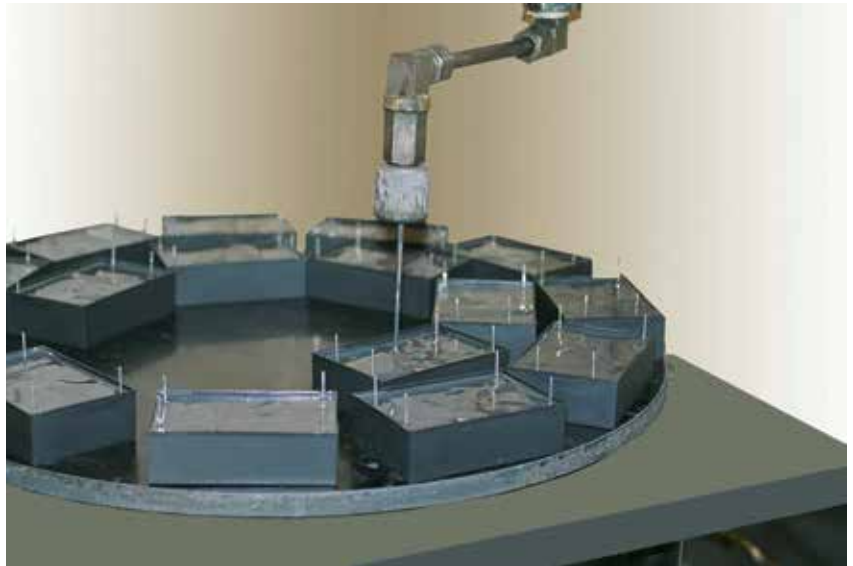
Abbildung 2: Die Isolationseigenschaften des beim thermoselektiven Vakuumpressen verwendeten Vergussharzes erlauben Ausführungen mit hohen Überspannungskategorien.
