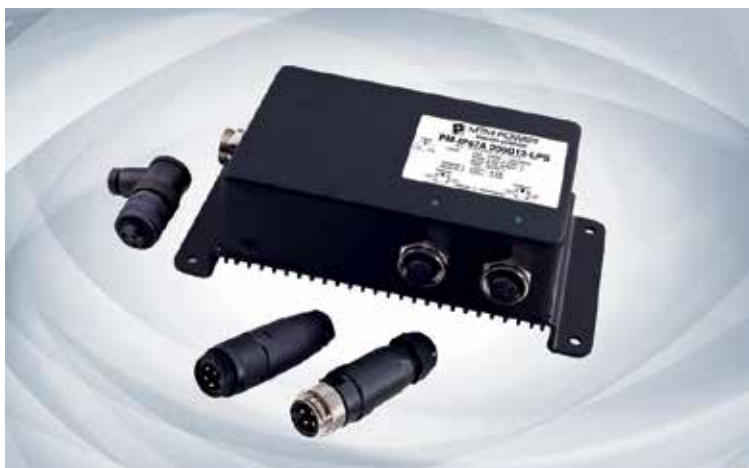
Abbildung 1: Durch die Kapselung der Elektronik mittels thermoselektivem Vakuumverguss wird die Schutzart der Stromversorgung durch die Anschlussstecker definiert.
