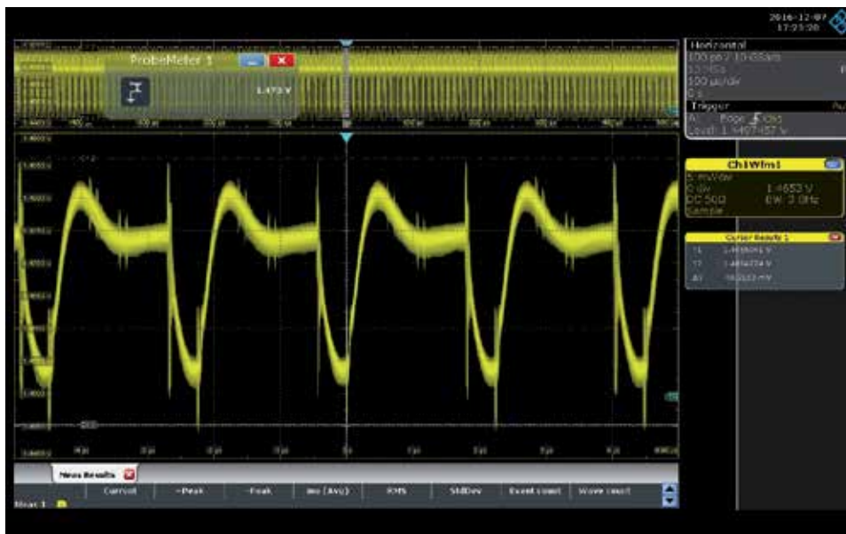
Abbildung 1: Spannungs-Ripple und die hochgenaue Messung der DC-Spannung mittels eines Probe-Meters (16-Bit ADC)
