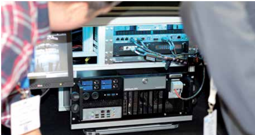
Abbildung 1: Ein im Testauto verbauter Messtechnik-Rechner „BRICK“ (oben) in Kombination mit dem HPC DATALynx ATX2 (unten)
