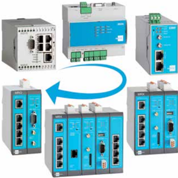
Abbildung 1: Jeder Router von Insys Icom verfügt über eine integrierte Linux-Umgebung zum Ausführen von Skripten und Programmen.
