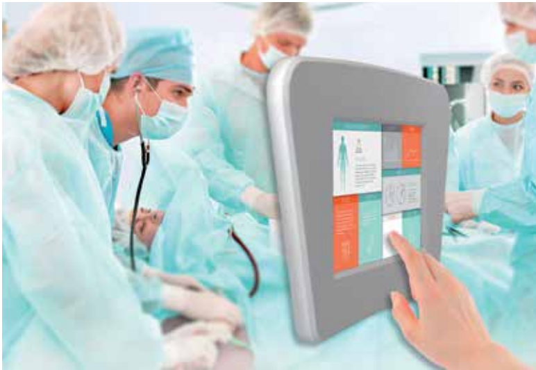
Abbildung 2: Eine Auslösen der Gerätefunktion kann bei einem Force-Touch-Display erst dann erfolgen, wenn beide Signale registriert werden - eine sinnvolle Ergänzung für die Intensivmedizin.
