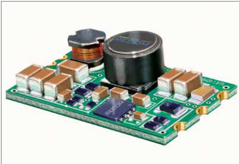
Abbildung 2: Der Low-Power-Schaltregler R-420-1.8/PL nutzt 3,6 mA der 4-20-mA-Schleife, um die Transmitter-Elektronik mit Strömen bis 10 mA zu versorgen.
