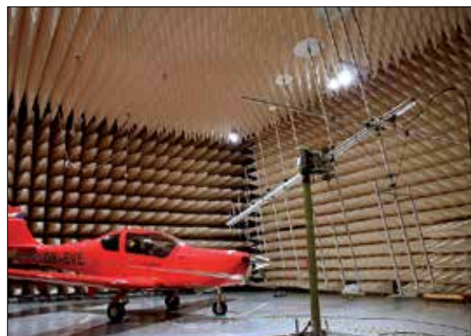
EMV-Messungen in Absorberhalle mit 10 m Messabstand
