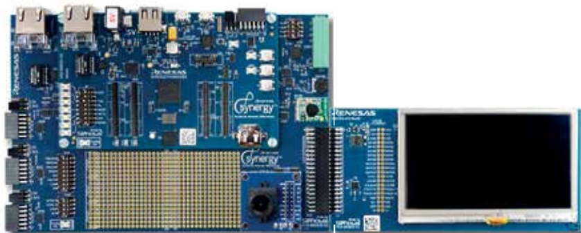
Das Synergy Development Kit für die MCUs der Serie S7 von Renesas bietet Zugriff auf alle Pins und sämtliche Debugging-Funktionen.
