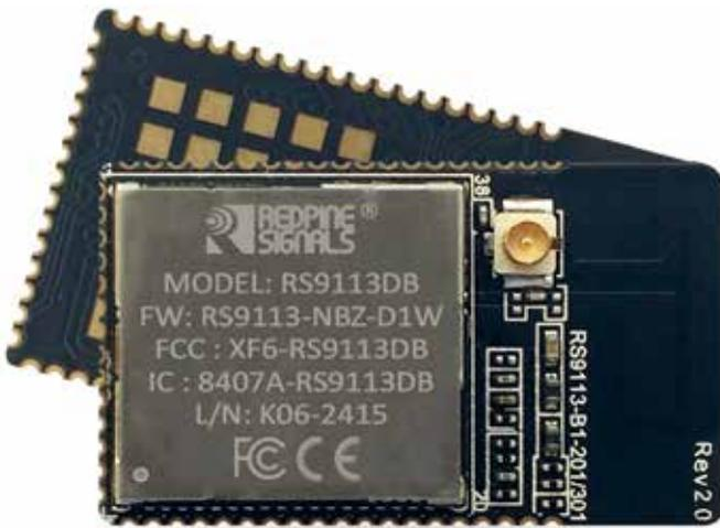
Kombimodule vereinen verschiedene Funkstandards. Das RS9113 von Redpine Signals verbindet zum Beispiel Bluetooth Low Energy und WLAN.
