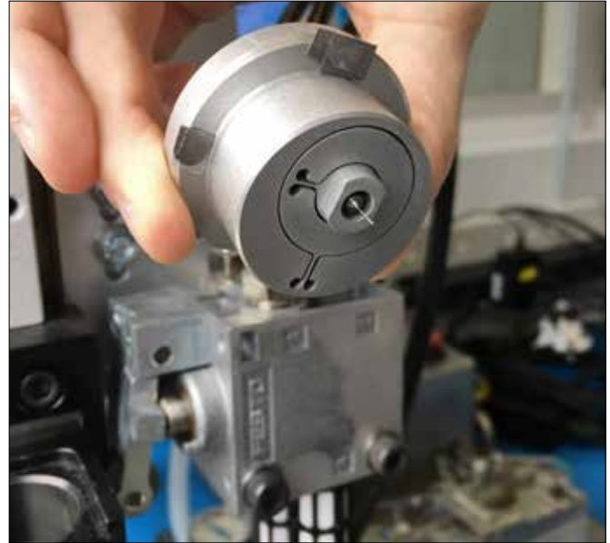
Beispiel eines Messaufbaus mit Sensor, Prüfling und Ausgleichselement (zum Patent angemeldet) zur Reduktion von Querkräften. Das abgestimmte Ausgleichselement enthält den hochauflösenden Kleinkraft-Sensor sowie die eingesetzte Prüfspitze.
