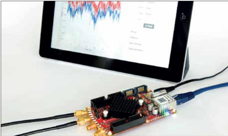
ARM-Prozessor und Linux-System sorgen dafür, dass die Messplattform Red Pitaya trotz hoher Leistung für unter 400 Euro zu haben sein wird.
