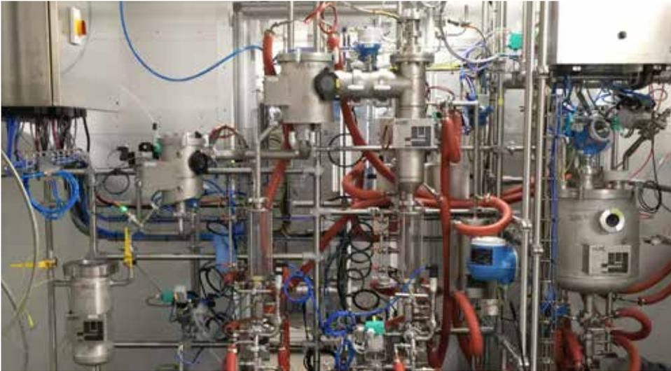
Beispiel für ein standardisiertes Anlagenmodul (PEA): Merck verwendet dieses zur Rektifikation (Gegenstromdestillation).
