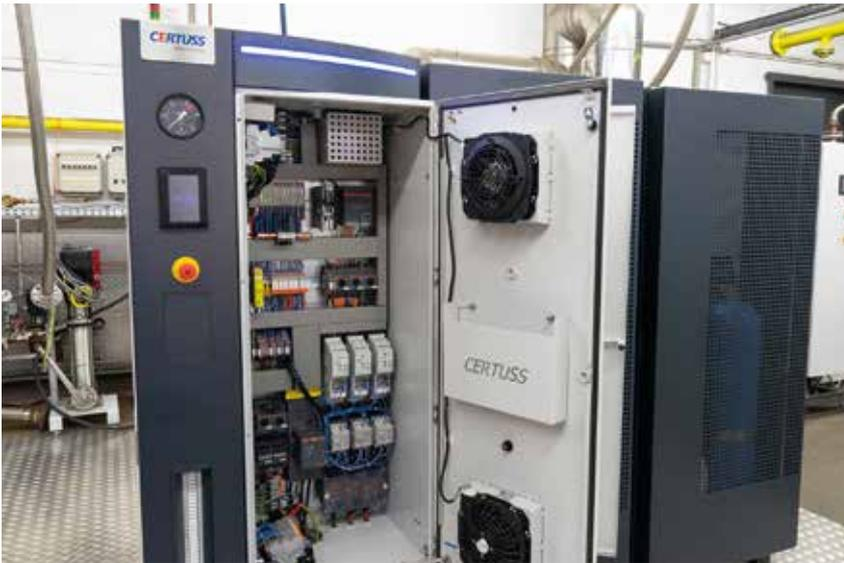
Die EMX-Dampferzeuger lassen sich variabel um weitere Module erweitern, wenn mehr Dampf im Prozess benötigt wird.
