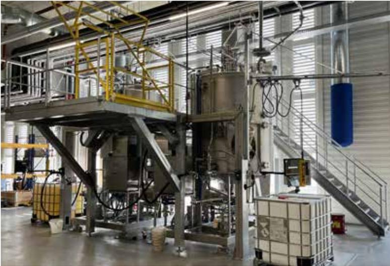
Der Duftstoffhersteller Luzi setzt an seinem Hauptsitz in Dietlikon (Schweiz) eine 3- und eine 5-Tonnen-Prozessanlage von Ystral für die Herstellung von Aromalösungen ein.
