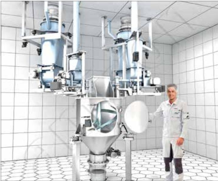
Der Kontinuierlich-Mischer AMK von Amixon kann auch als Präzisions-Chargenmischer eingesetzt werden.
