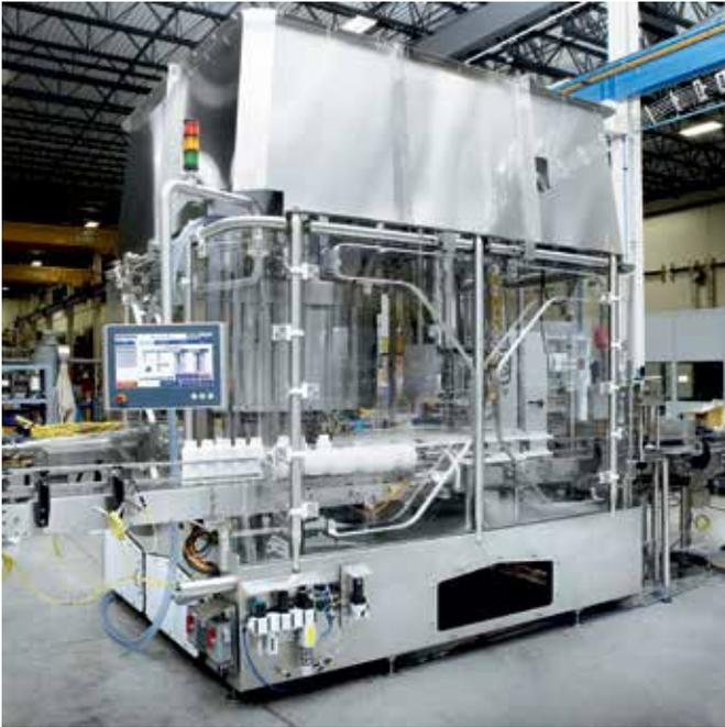
Bei der berührungslosen Abfüllung von Flüssigprodukten erzielt die XACT-FIL-Maschine 5.000 Gewichtsmessungen pro Sekunde und eine Genauigkeit von  $\pm 0,5$  Prozent.
