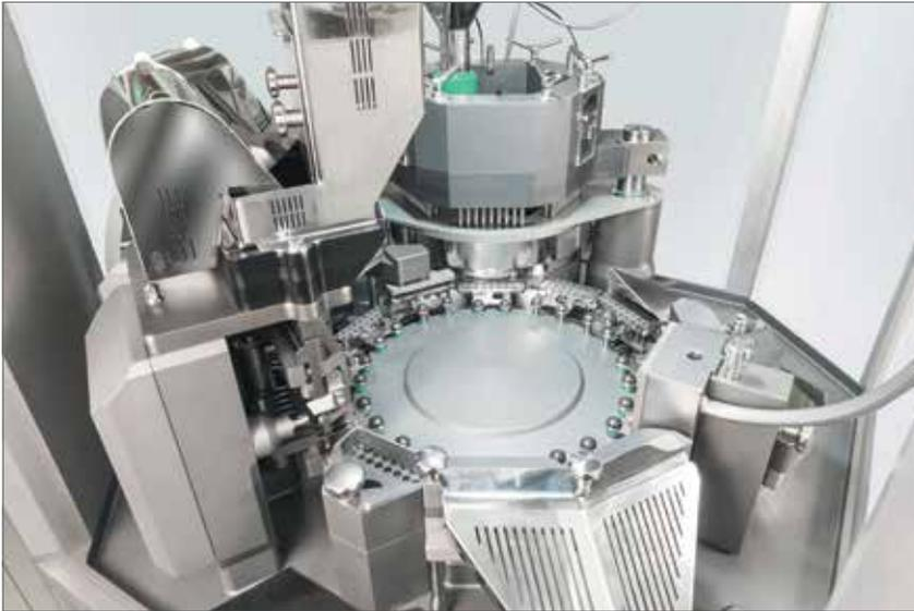
Bei Wiewelhove kommt die GKF 2600, die für den Hochleistungsbereich entwickelt wurde, bei Kapselgröße 00 auf mehr als 110.000 Kapseln pro Stunde.
