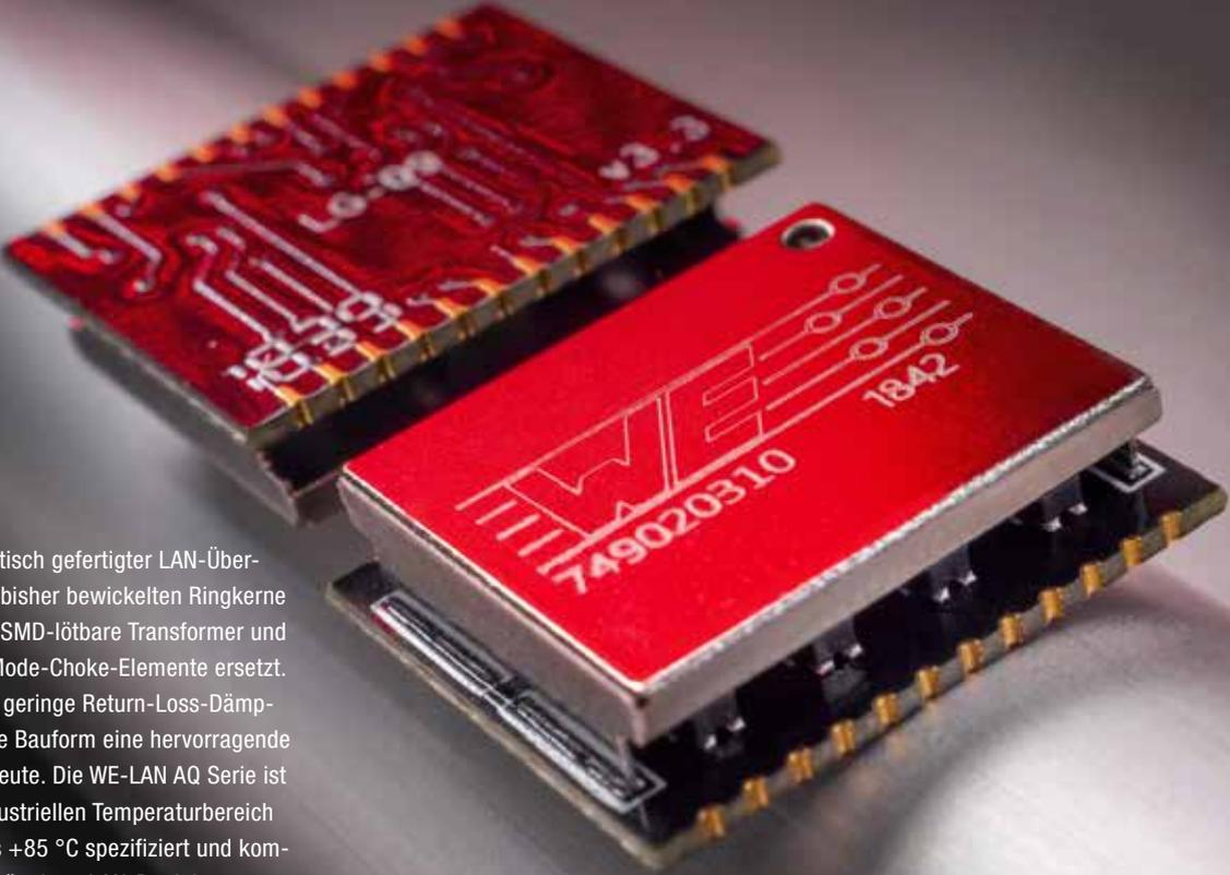
Vollautomatisch gefertigter LAN-Übertrager: Die bisher bewickelten Ringkerne sind durch SMD-lötbare Transformer und Common-Mode-Choke-Elemente ersetzt. Durch eine geringe Return-Loss-Dämpfung hat die Bauform eine hervorragende Signalausbeute. Die WE-LAN AQ Serie ist für den industriellen Temperaturbereich von -40 bis +85 °C spezifiziert und kompatibel zu gängigen LAN-Produkten.
