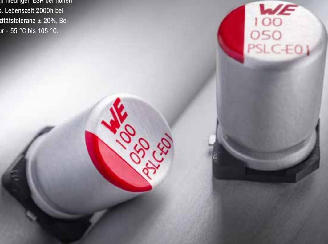
Aluminium-Polymer-Kondensator zeichnen sich durch einen niedrigen ESR bei hohen Frequenzen aus. Lebenszeit 2000h bei +105 °C, Kapazitätstoleranz  $\pm 20\%$ , Betriebstemperatur - 55 °C bis 105 °C.
