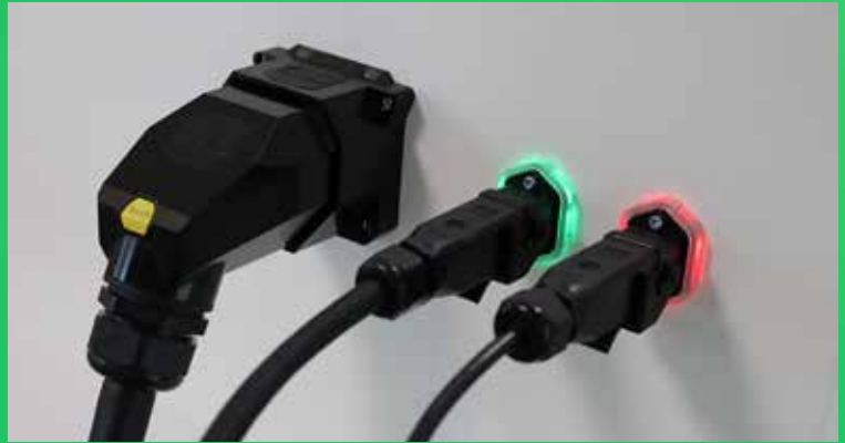
Technologiedemonstrator Smarte Steckverbinder (SmEC) mit Status-Anzeige und Identifikation.
