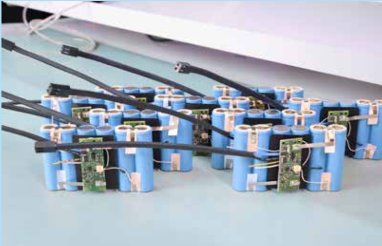
PCM oder BMS? Je nach Anforderung kommen unterschiedliche Schutzelektroniken zum Einsatz.
