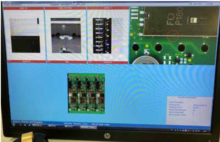
Die Verwendung von AOI-Software zur Verringerung von Pseudofehlern steigert die Erstaussbeute um 42 Prozent.
