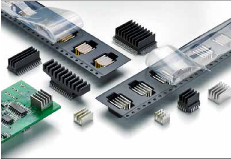
Gewichtsoptimierte SMD-Kühlkörper zur direkten Verklebung auf dem Bauteil oder Verlötlung auf der Leiterkarte für die Wärmeableitung kleinerer Verlustleistungen.
