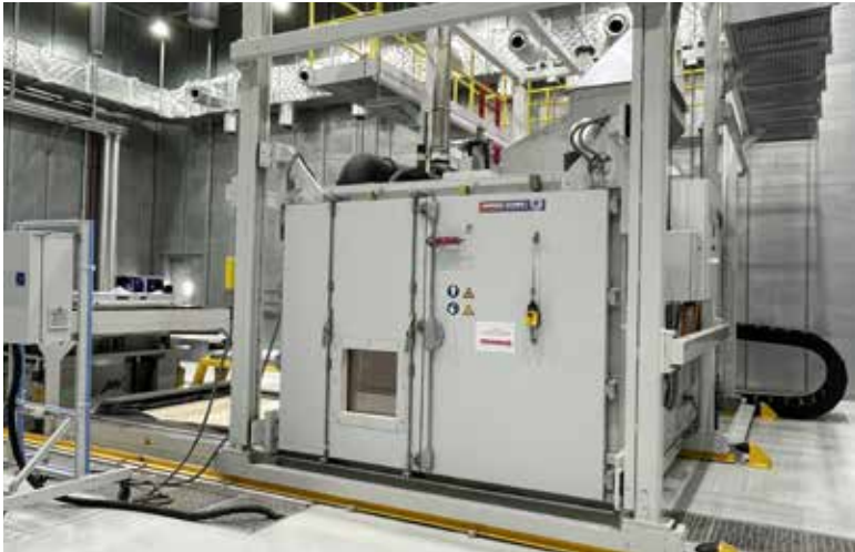
Die Spezialisten von Andreas Schmid hat für einen Anwender eine spezielle Festkammer entwickelt, die Vibrations- und Klimasimulationen in derselben Anlage ermöglicht.
