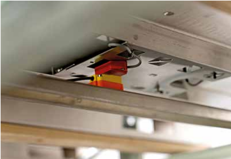
Am RFID-Datenträger ist ein Sensor-Element angeschlossen, das die Temperatur im Inneren des Lagerbehälters misst.
