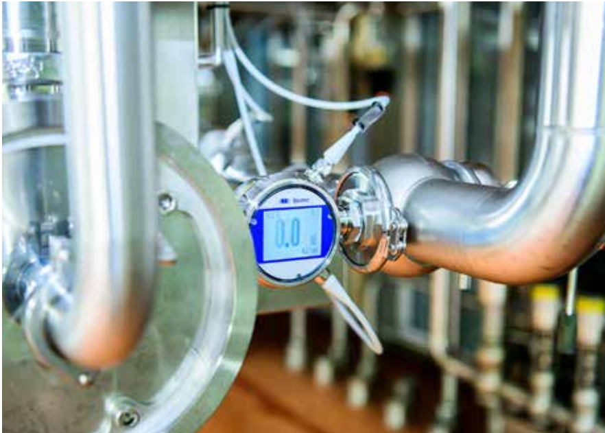
Mit dem Baumer-Leitfähigkeitssensor CombiLyz AFI kann Züger während des CIP-Reinigungsprozesses bis zu 100.000 l Wasser pro Tag einsparen.
