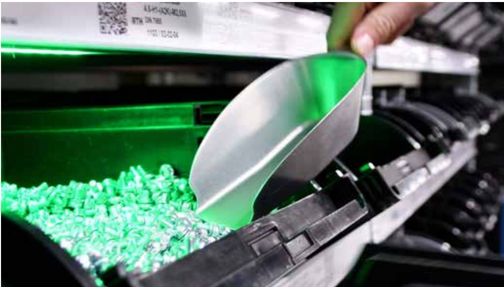
Die benötigten C-Teile werden angeleuchtet und können direkt entnommen werden; die WLS15-Linienleuchten sind hinter dem Falz des Regalblechs montiert.
