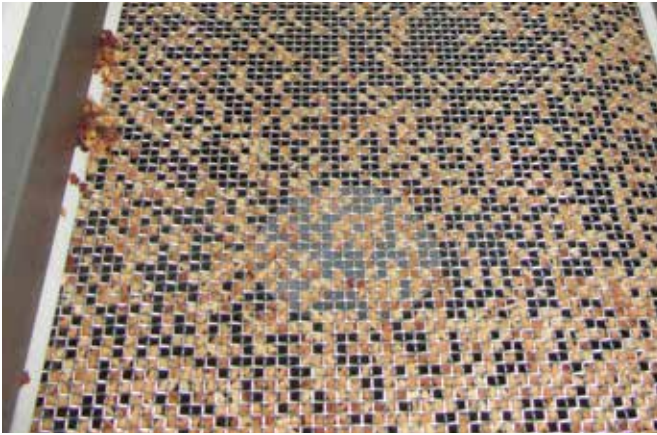
Nussplitter sind fetthaltig, kantig und setzen als Steckkorn schnell das Siebgewebe zu.
