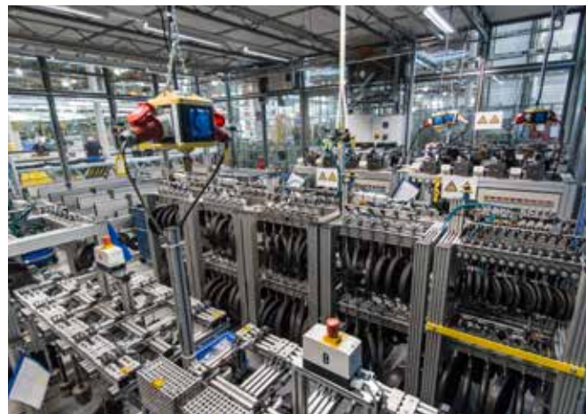
Igus entwickelt und testet seine Gleitlager im größten Testlabor der Branche. 15.000 Verschleißtests finden pro Jahr auf mehr als 450 Prüfstellen statt.
