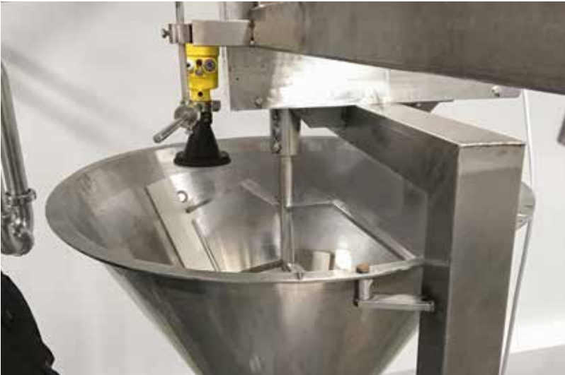
Der Vegapuls misst – dank des schmalen Messstrahls – innerhalb eines sehr schmalen Radius.
