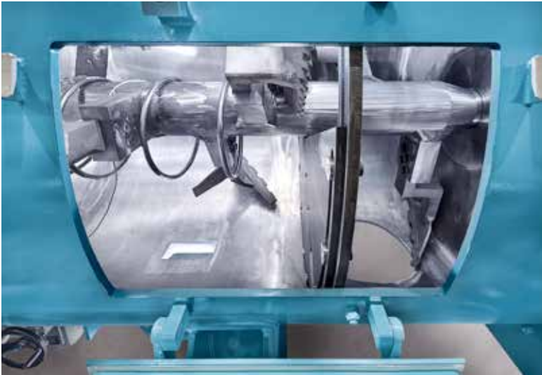
Da Flugaschen als besonders abrasiv gelten, kommen Mischwerkzeuge in einer Heavy-Duty-Ausführung zum Einsatz.
