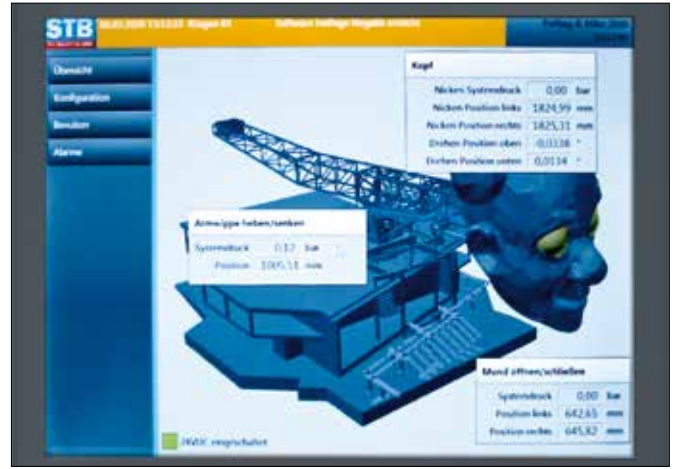
Im Hauptschrank und im Bedienstand zur Ansteuerung der Hydraulik ist jeweils ein 15-Zoll-Multitouch-Einbau-Control-Panel CP2915 von Beckhoff im Einsatz.
