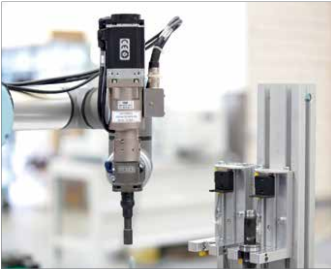
Der Leichtbau-Schrauber SEV-P von Weber Schraubautomaten lässt sich schnell und einfach an unterschiedliche Anwendungen anpassen. Auch ein automatischer Werkzeugwechsel ist möglich.
