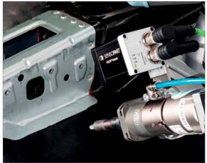
Der Vision-Sensor liefert die benötigten Umgebungsinformationen. Position und räumliche Orientierung des Werkstücks werden anhand der beiden charakteristischen Öffnungen im Blech erkannt.
