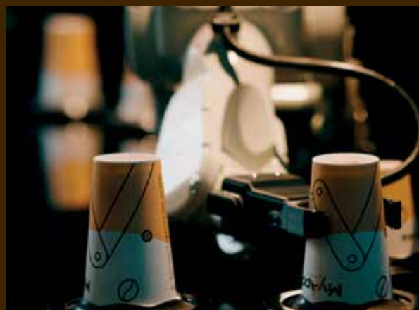
Übernimmt das Kaffeebecherhandling: Ein elektrischer 2-Backen-Parallelgreifer der Serie GEP2000 der Zimmer Group.
