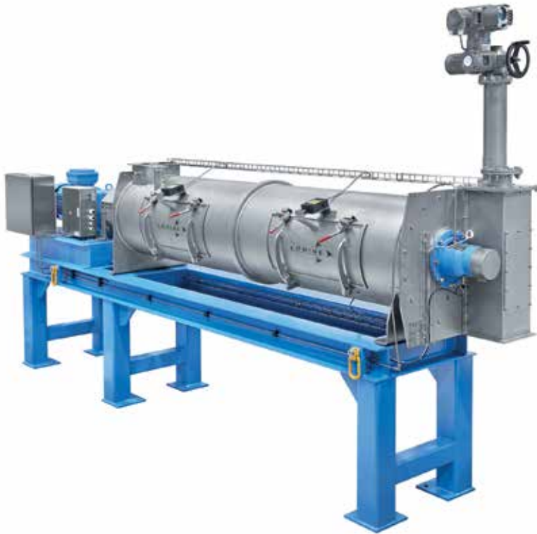
Pflugschar-Mischer für den kontinuierlichen Betrieb sind besonders auf hohe Durchsatzleistungen ausgelegt.
