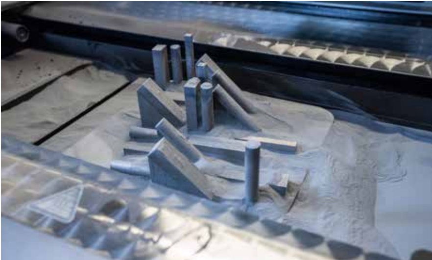
Im Pulverbettverfahren entsteht das Bauteil Schicht für Schicht. Überschüssiges Metallpulver lässt sich meist weiterverarbeiten.
