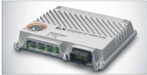
Der PC für mobile Maschinen von B&R verfügt über einen Intel-Prozessor, der über einen weiten Bereich skalierbar ist.
