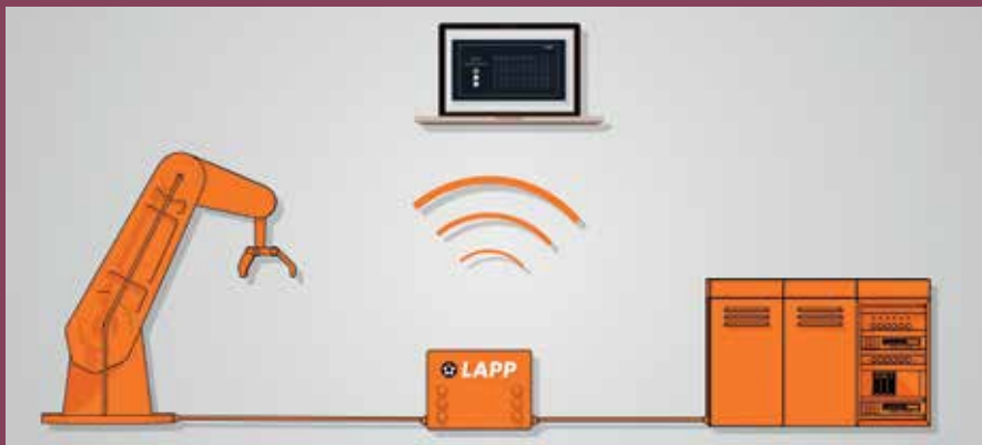
Die Predictive Maintenance Box von Lapp ist klein wie eine Zigarettenschachtel und wird einfach in die zu überwachende Leitung eingeschleust.
