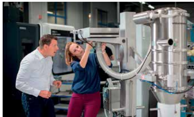
Mobiler Vakuumpförderer (rechts) in höhenverstellbarem Fahrwagen (Mitte) bei der Vorabnahme im Herstellerwerk
