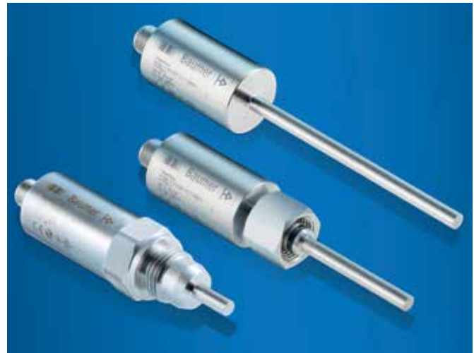
Strömungssensoren mit verschiedenen Prozessanschlüssen: Bei Sinteröfen kommen häufig Dichtkegelanschlüsse zum Einsatz. Die metallische Dichtung mit zusätzlicher O-Ring-Kunststoffdichtung ist druckfest bis 100 bar.
