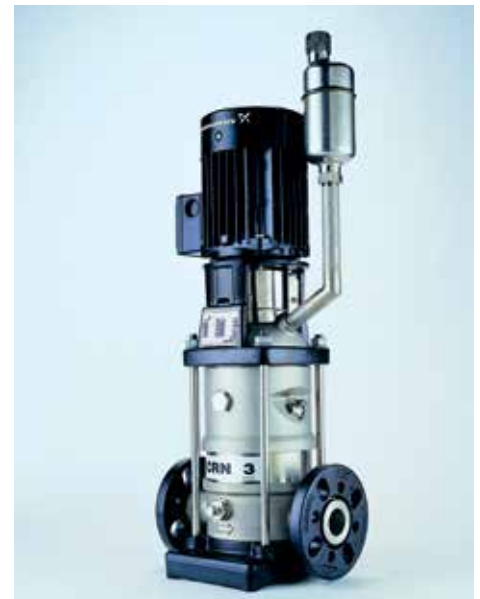
Die Variante CR Air-cooled Top mit luftgekühlter Wellendichtungskammer fördert Wasser mit einer Temperatur bis 180 °C und Wärmeträgeröle bis 240 °C ohne externe Kühlung.
