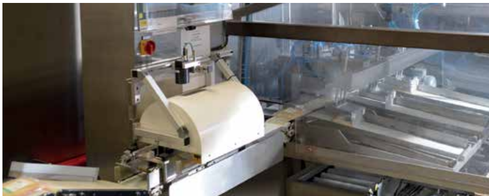
Die Käseverpackungen laufen an dieser Station von links kommend unter dem Bildverarbeitungssystem hindurch und werden nach der Inspektion von einem Roboter in Transportkisten abgelegt.
