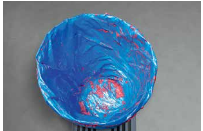
Nahezu restlos: Auch anspruchsvolle Medien fördert Viscoflux mobile S mit Restmengen bis unter einem Prozent.
