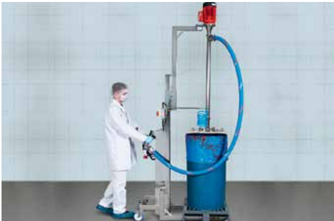
Tomatenmark fördern leicht gemacht: Viscoflux mobile S lässt sich an das Fass fahren und von einem Mitarbeiter bedienen.
