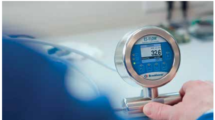
Der Durchflussmesser ES-FLOW misst Flüssigkeitsvolumenströme zwischen 4 und 1.500 ml/min – unabhängig von Flüssigkeitsdichte, Temperatur und Viskosität.
