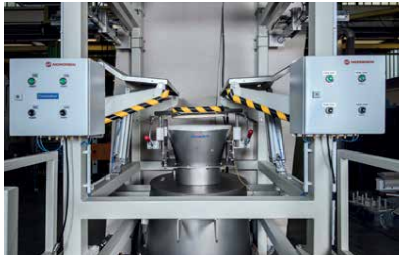
Balkendruck- und Walkvorrichtung brechen die großen Agglomerate im Big Bag auf und sorgen für eine schnelle und nahezu restlose Entleerung.
