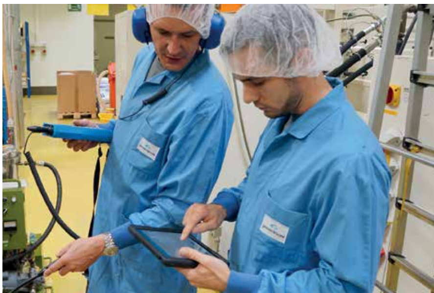
Während Heiko Leonhardt (links) mit Hilfe eines Ultraschallmessgeräts die Leckagen ortet, erfasst Manuel Stephan (rechts) die Messwerte auf dem Tablet.
