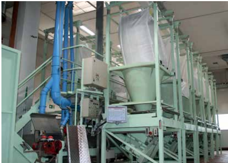
Die Tee-Komponenten werden aus mehreren Big-Bag-Stationen dosiert.
