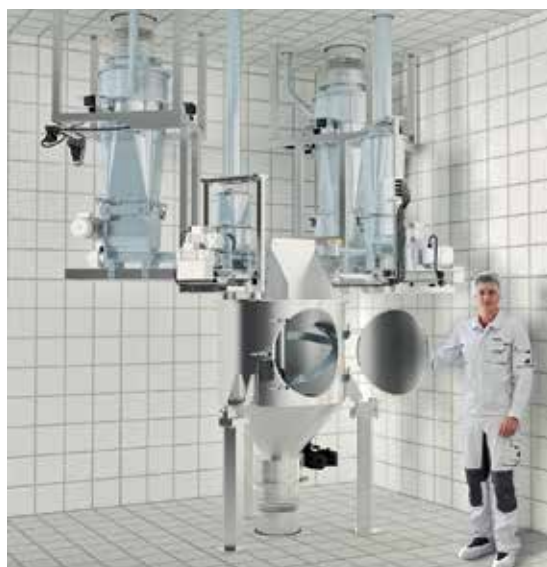
Der Kontinuierlich-Mischer von Amixon mit vier gravimetrisch arbeitenden Dosiersystemen. Der Mischer ruht auf Wägezellen; Einfüllstutzen und Austragsstutzen sind mit flexiblen Manschetten versehen.
