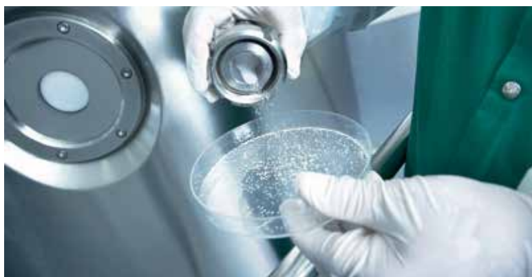
Für den Pelletaufbau wird das Luftgleitschichtverfahren eingesetzt.
