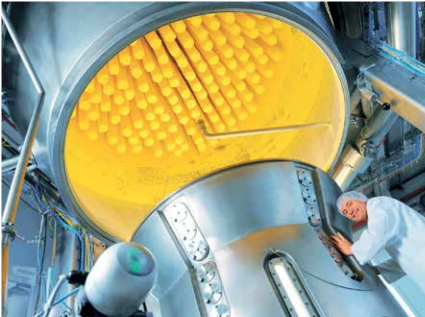
Mittels Wirbelschichttechnik können Produkteigenschaften bestmöglich eingestellt werden.
