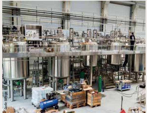
Fertigung von Super-Skids bei Bilfinger Industrietechnik Salzburg
