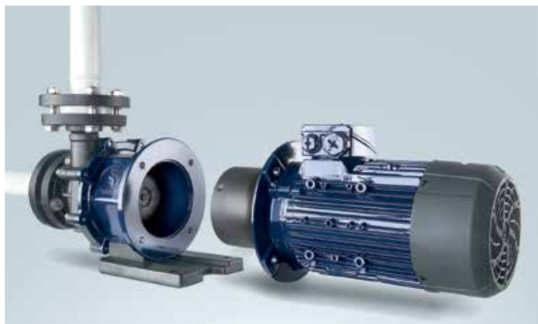
Das Back-pullout-Design ermöglicht einen Motoraustausch bei hermetisch geschlossener Anlage. Das reduziert Ausfallzeiten deutlich.
