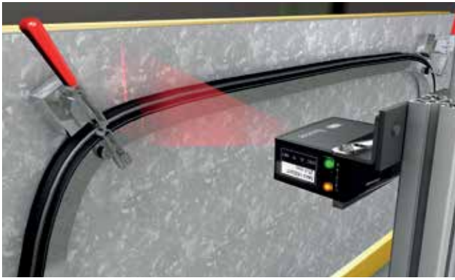
Die Höhe der Gummidichtungen für Seitenscheiben in der Automobilindustrie werden per At-Line-Qualitätskontrolle erfasst.
