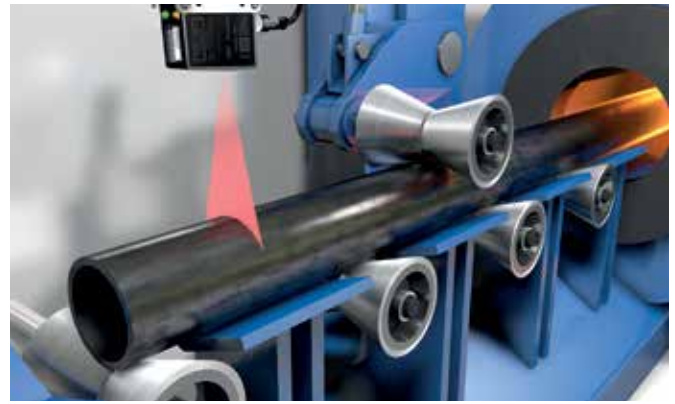
Bei der Kontrolle von Stahlrohren misst der Lichtschnittsensor den Durchmesser mit absoluten Messwerten.
