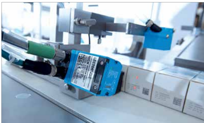
Der kamerabasierte Codeleser Lector62x ist ein intelligenter Sensor zur automatischen, stationären Decodierung von Codes auf bewegten oder unbewegten Objekten.
