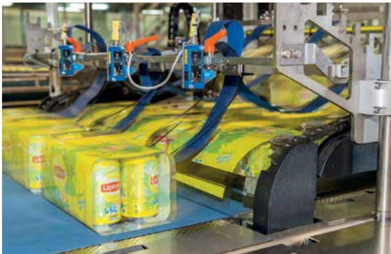
Die Highspeed-Variante der Verpackungsmaschine Variopac Pro TFS arbeitet mit bis zu 120 Takten pro Minute und Bahn.
