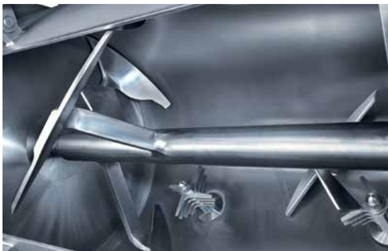
Pflugschar-Mischer sind zum Herstellen diätischer Zusatzstoffe eine Alternative zum Wirbelschichtverfahren.
