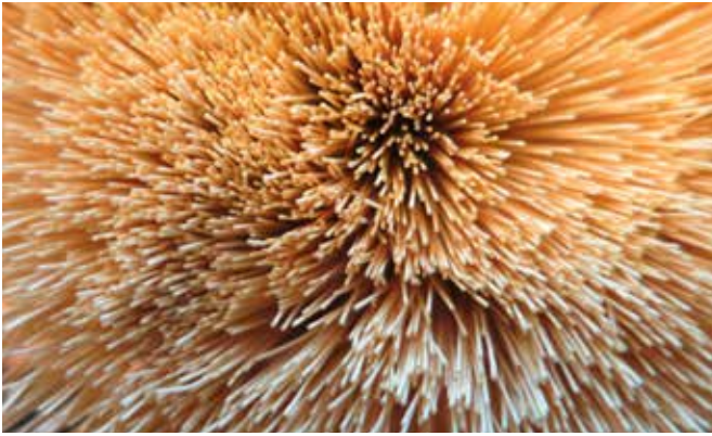
Hohlfasermembranen sorgen in Biogasanlagen dafür, dass das Methan seine Reinform behält.
