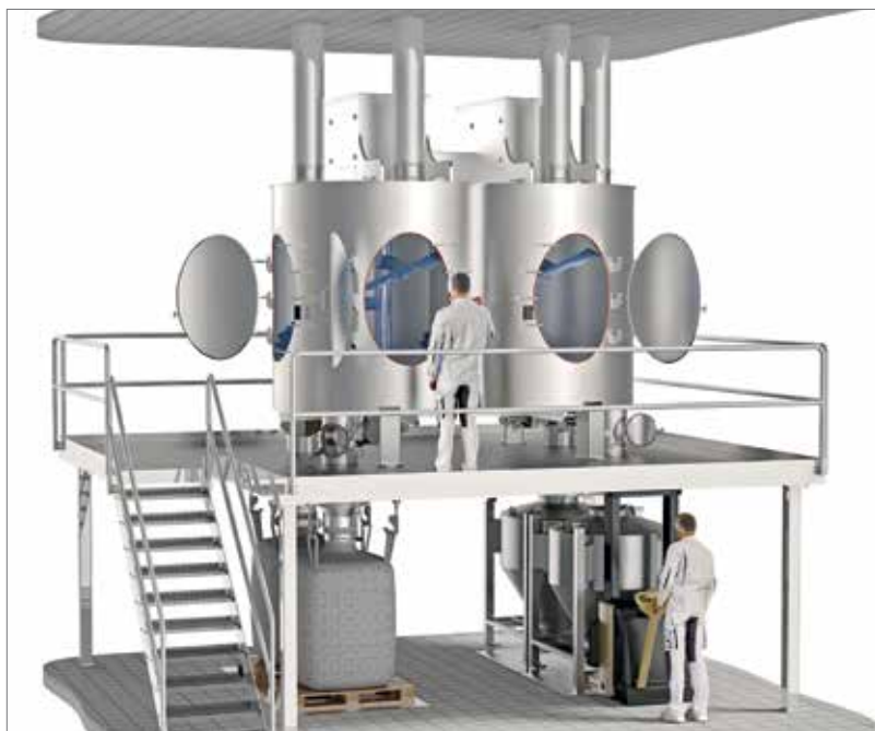
Der HM 1000 mit zehn Kubikmetern nutzbarem Volumen und vier Austragsorganen. Für die Wartung sind die acht ovalförmigen CleverCut-Inspektionstüren installiert. Vier Waagen erfassen die Gebindegewichte.
