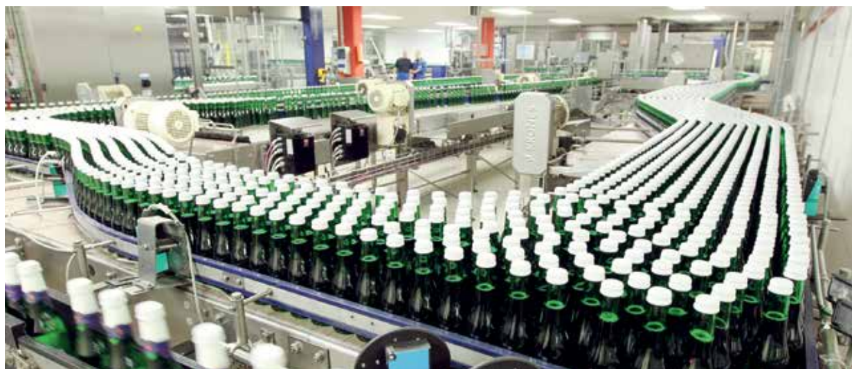
Die Sektkellerei Matheus Müller befüllt die Sektflaschen im Dreischichtbetrieb an fünf Tagen pro Woche. Mehr als 75 Millionen Sektflaschen sind es jedes Jahr, darunter auch Piccolo-Flaschen.
