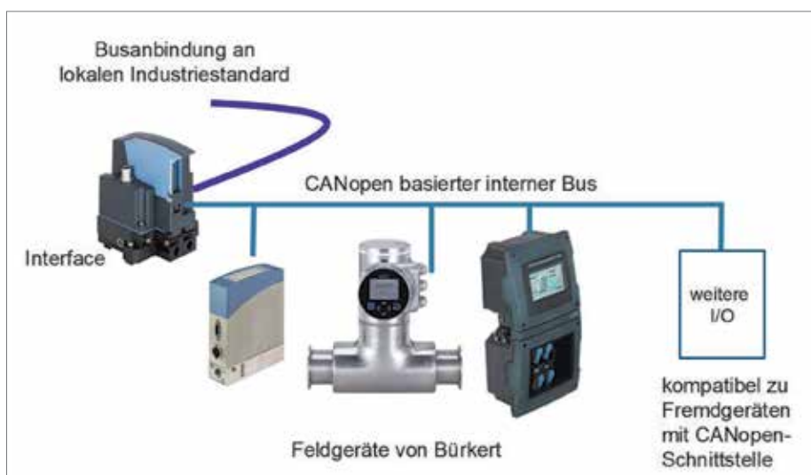
Die Plattform EDIP kommuniziert über den Standard CANopen mit den angeschlossenen Geräten, wie zum Beispiel Durchflussmessern oder Analyse-Systemen.
