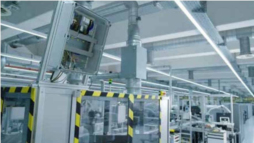
Mit der Data Collection Box gelingt es, digitale Daten aus der Fertigung zu gewinnen, ohne die laufenden Prozesse zu stören.
