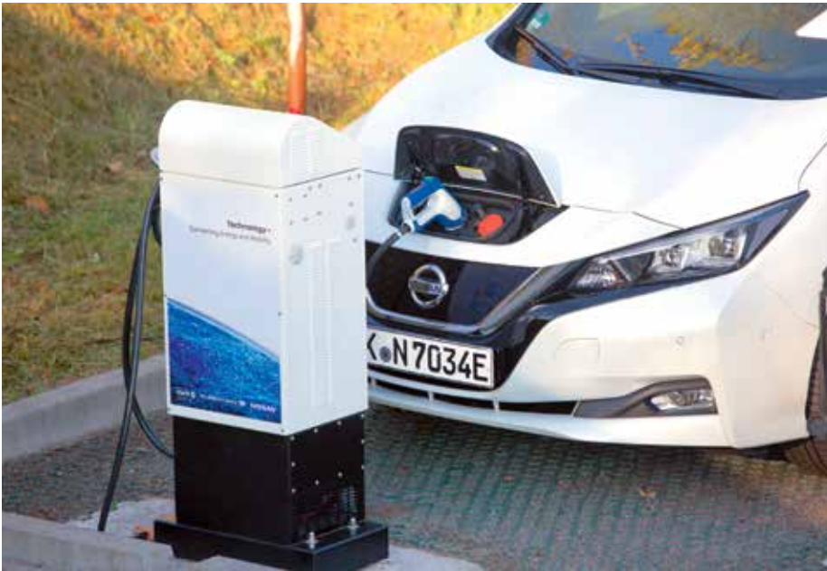
Der Nissan Leaf ist als erstes mobiles Kraftwerk in Europa offiziell zugelassen und kann in Sekundenschnelle Schwankungen im Stromnetz ausgleichen.
