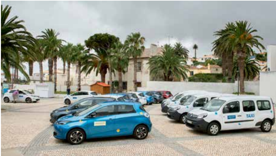
Derzeit umfasst die Flotte 20 unidirektionale E-Fahrzeuge und zwei bidirektionale Renault Zoe mit einer Batteriekapazität von je 40 kWh.
