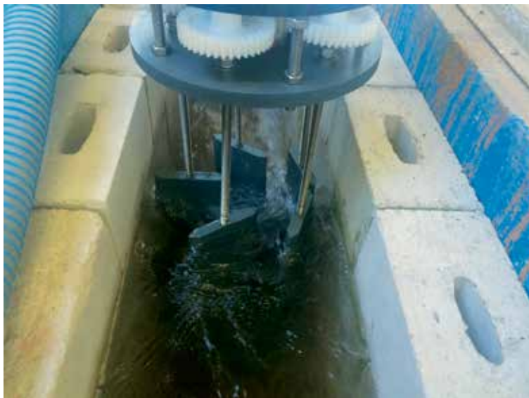
Ein spezielles Planetengetriebe mit dreifachem Zahneingriff ermöglicht dabei einen gleichmäßigen Bewegungsablauf bei einem Übersetzungsverhältnis von 2:1. Damit ist seine Funktionsweise gewährleistet, auch wenn er vollständig untergetaucht ist.
