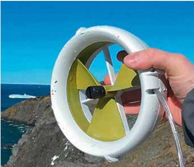
Seaformatics: Eine Mini-Turbine für die Hosentasche spendet Strom mit Hilfe von Wind, Wasser und Muskelkraft.
