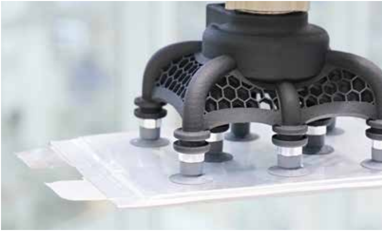
Der Leichtbaugreifer SLG mit SFF-Sauggreifern handhabt Pouchzellen. Die strukturierten Sauger verhindern ein Tiefziehen der Gehäusefolien.
