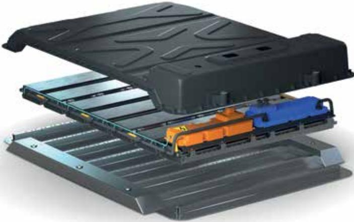
Das Batteriekonzept des Konsortiums setzt sich aus einer flachen Aluminiumbodenplatte mit Querträgern zum Befestigen der Batteriemodule sowie einer Trägerplatte für das Management des Batteriesystems und dem dreidimensionalen Gehäusedeckel aus einem glasfaserverstärktem Epoxid-SMC zusammen.
