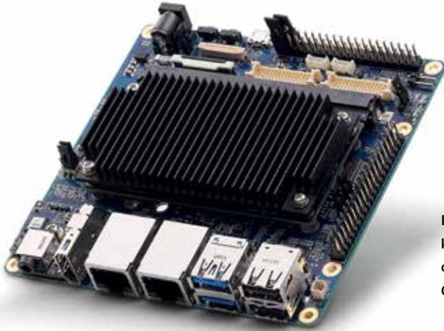
Die Prototypenbauplattform I-Pi SMARC Plus kombiniert die Flexibilität eines Raspberry Pi oder Arduino Systems mit der Robustheit eines Computer-on-module (COM) in Industriequalität.
