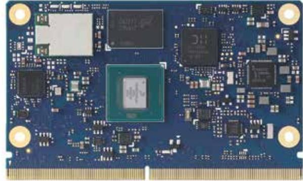
tem-on-Chip, der auf einem Quad Core Arm Cortex-A53 basiert, mit optionaler integrierter NPU und bis zu 8 GB Speicher. Die Signale von zwei GbE LANs, zwei USB-3.0-Ports, drei USB-2.0-Ports und einem USB-2.0-OTG-Port, einem MIPI DSI mit vier Lanes, einem MIPI CSI mit vier Lanes und einem MIPI CSI mit zwei Lanes sowie CAN-, SPI-, UART- und I2C-Schnittstellen, neben etlichen GPIO's, werden über den MXM-3.0-Konnektor an die beziehungsweise von der I-Pi-Trägerplatine übermittelt.
