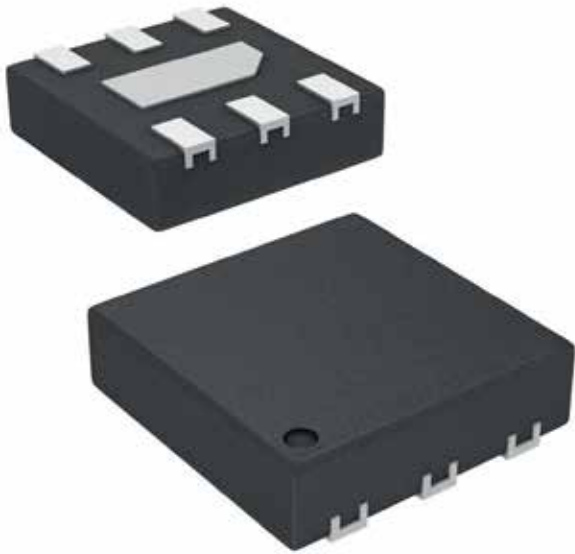
Der LDO-Controller ISL9016 von Renesas kann auf jedem Kanal bis zu 150 mA Strom liefern.
