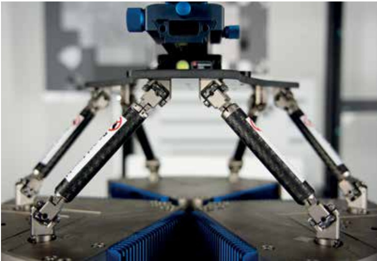
Der Hexapod H-860 mit magnetischen Direktantrieben bietet Simulationsfrequenzen von bis 30 Hz und fährt vordefinierte Trajektorien, Sinuskurven und frei definierbare Bahnen mit hoher Bahntreue ab.
