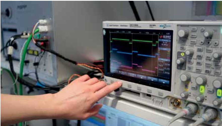
Zur Validierung von RGB-LED-Modulen ist ein technisch anspruchsvoller Prüfstand notwendig.
