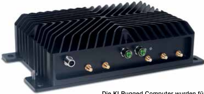
Die KI Rugged Computer wurden für den Einsatz unter Extrembedingungen entwickelt. Sie erfüllen die Schutzklasse IP67.
