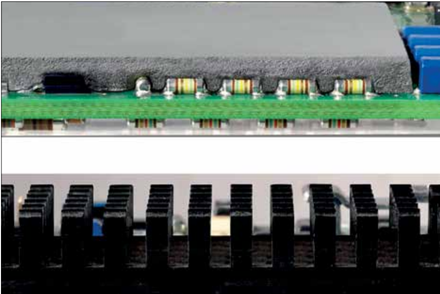
GEL-Folien liefern ausgezeichnete Anpassungsmöglichkeiten von Kontaktpaarungen mit größeren Fertigungstoleranzen und Bauteildifferenzen.
