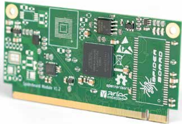
Zum SpiderSoM-Modul bietet Aries Embedded einen RISC-V Softwarecore, der durch FreeRTOS unterstützt wird.
