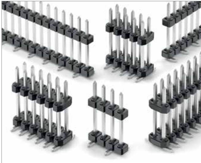
SMD-Steckverbinder sparen bis zu 50 Prozent an Platz im Vergleich zu THT-Pendants.
