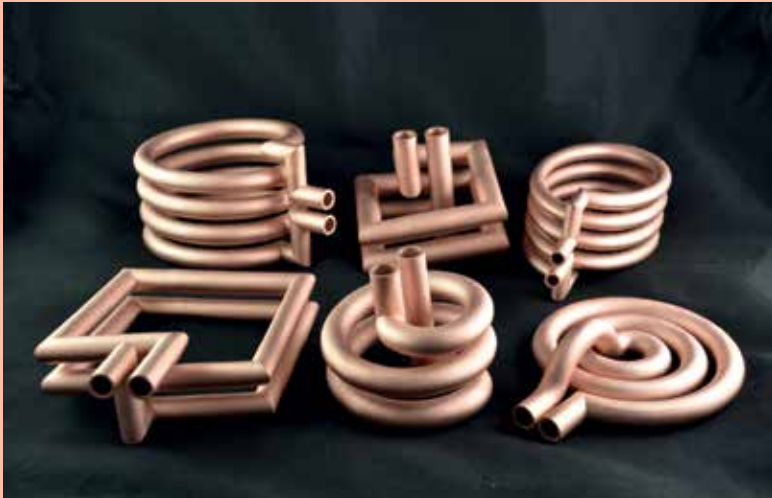
Induktionsspulen aus dem 3D-Drucker: Online konfigurierte Induktionsspulen aus elektrisch hochleitfähigem Kupfer bieten zahlreiche Vorteile.
