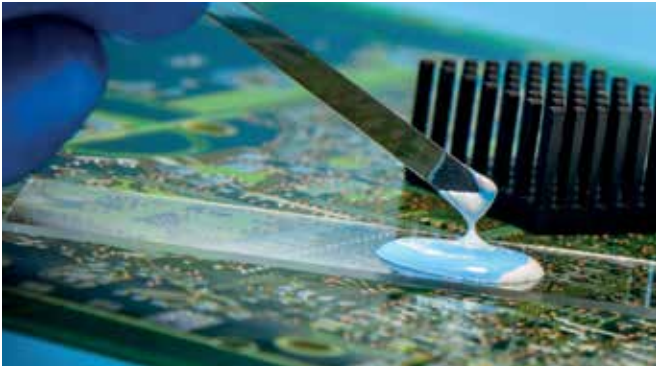
Aufgrund ihrer Dicke bieten Harze einen hohen Schutz von Leiterplatten.
