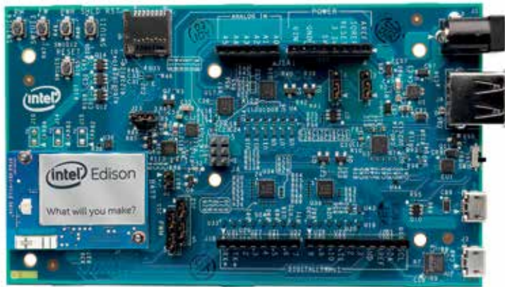
Die Edison-Erweiterungskarte von Intel ermöglicht den komfortablen Anschluss an eine Prototyping-Hardware.
