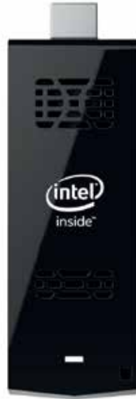
Der Compute-Stick von Intel verwandelt einen HDMI-Fernseher im Handumdrehen in einen voll funktionsfähigen Computer.
