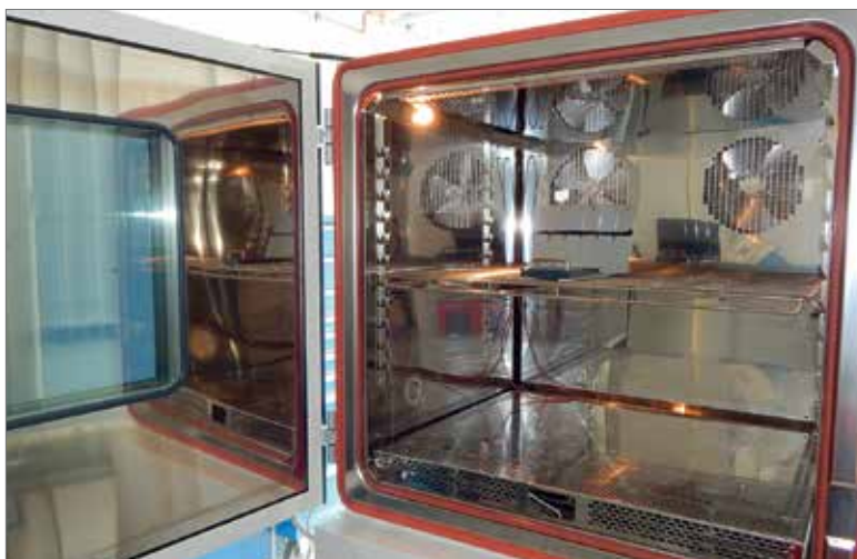
In Klimakammern werden Bauteile Temperaturen von -40 bis 180 °C ausgesetzt. Noch belastender als große Hitze oder Kälte sind für die Bauteile aber schnelle Temperaturwechsel.
