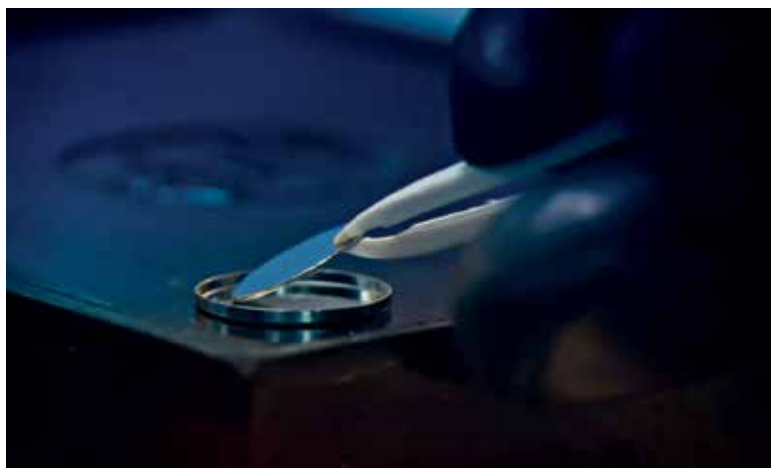
Präparation einer Batterie im Knopfzellenformat: Forscher der TU Bergakademie Freiberg arbeiten an einer Batterie auf Aluminium-Basis.
