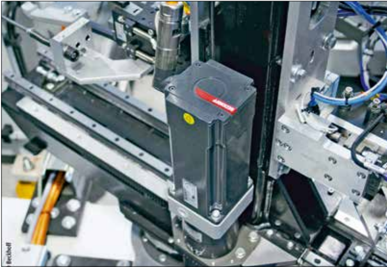
Das dezentrale Anschlusskonzept auf Basis von EtherCAT P und die kompakten Servoantriebe AMP8000 sparen wertvollen Platz in der Maschine.
