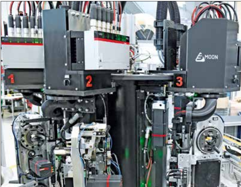
Das neue Maschinenkonzept von Borghi auf Basis flexibler Bearbeitungsrevolver und dem dezentralen Servoantriebssystem AMP8000 mit Versorgungsmodulen AMP8620 ermöglicht eine kontinuierliche Herstellung von Besen und Bürsten.
