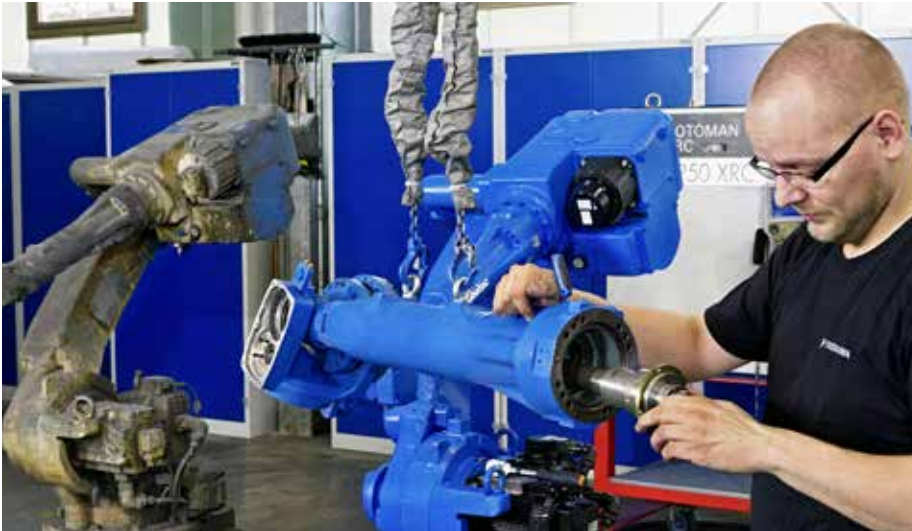
Durch ein Retrofit kann ein in die Jahre gekommener Roboter planmäßig überholt oder ausgetauscht werden.
