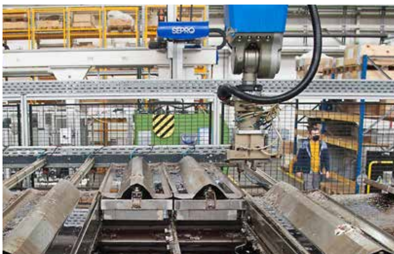
Ein Blick in einen Ausschmelztank: Die Abdeckungen öffnen sich zum Beschicken automatisch.
