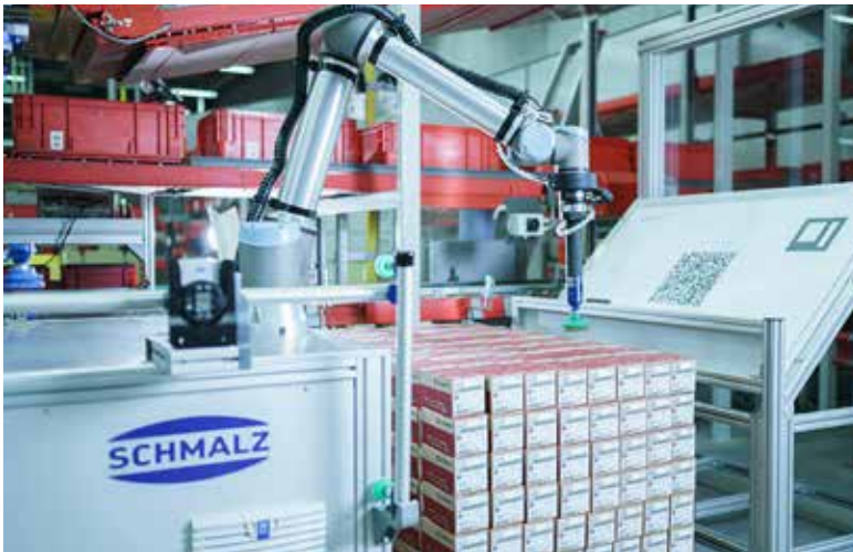
Neuer Kollege: Im Würth Verteilerzentrum VZ West unterstützt seit wenigen Monaten ein Cobot, ausgestattet mit Schmalz-Technologie, die Fachkräfte beim Beladen der Kleinladungsträger.
