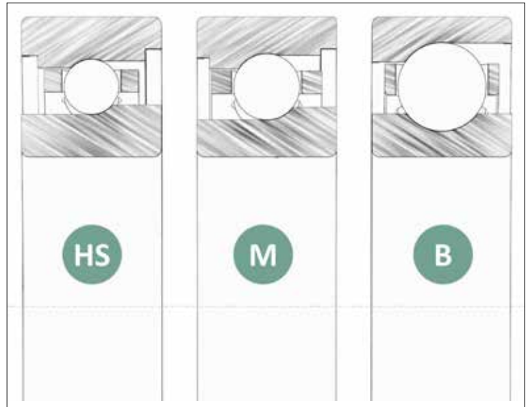
Freie Auswahl und flexibel anpassbar: Die drei Spindellagerbaureihen mit unterschiedlichen Innengeometrien.
