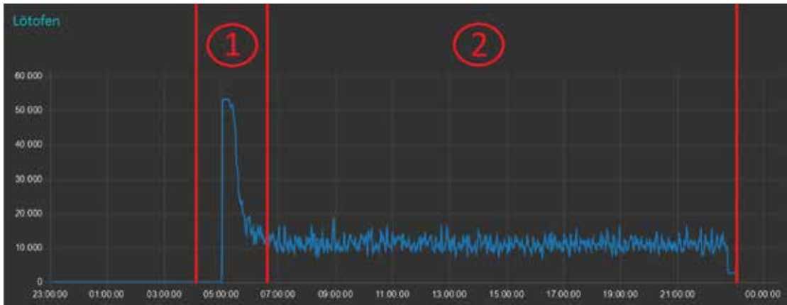
Darstellung des Energieverbrauchs des Lötöfens über einen 24-Stunden-Zeitraum und Unterteilung in verschiedene Phasen. Phase 1: Einschaltphase, Phase 2: Warmhaltephase.
