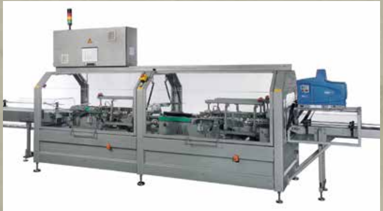
In den Verschließmaschinen von Econo-Pak werden Faltschachteln mit hohen Geschwindigkeiten befördert und mit Heißleim oder -luft verschlossen.
